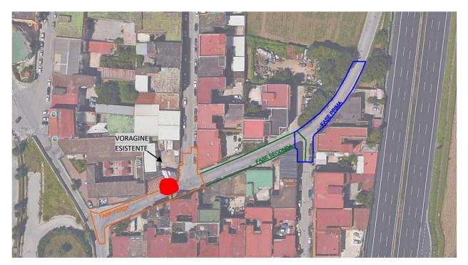
abitato, dove la posizione delle tubazioni in relazione alla larghezza della carreggiata non permette la chiusura parziale della carreggiata; è stata predisposta una compartimentazione dei singoli tratti in modo da eseguire le lavorazioni in fasi. A tal proposito per l'esecuzione dell'intervento si sono individuate quattro macro fasi di lavorazioni riportate nella tavola SIC 03 – Organizzazione di Cantiere.
